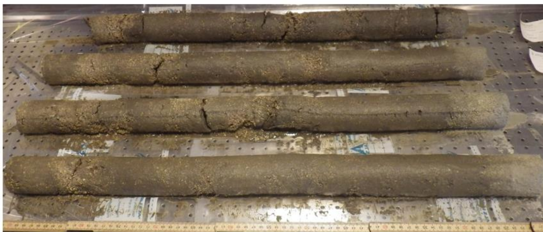
Figur 5-1: Representativ prøvemateriale fra grabbprøver ST1 og ST4-ST7 øverst samt dypere prøve ST7 nederst.
