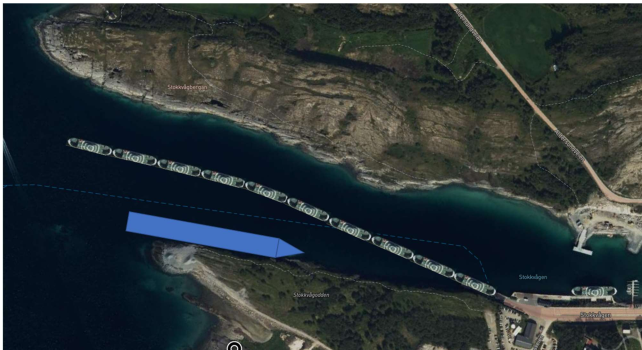
Figur 26 Illustrasjon av innfart til dagens bilferje med et objekt på over 150 m lengde og 30 m bredde liggende langs Stokkvåggodden. Kilde: forslagsstiller.
