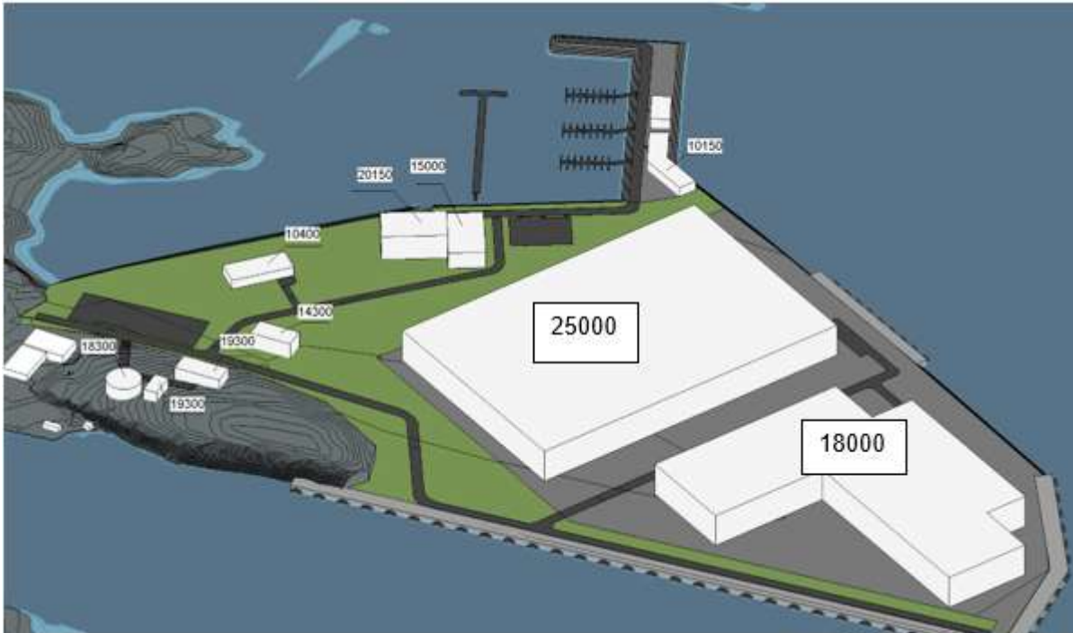
Figur 9 Byggehøyder angitt som kotehøyder i mm. På illustrasjonen er kai og planert område vist som kote +4.
