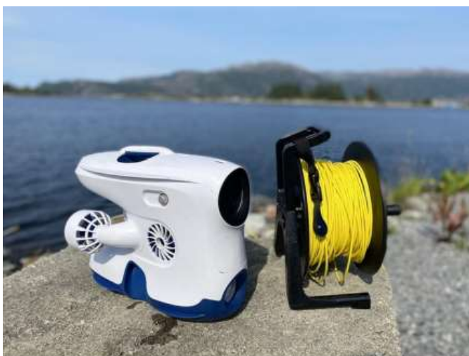
Figur 3-1. ROV (Blueye Pioneer), Ipad og konsoll ble brukt til kartlegging av sjøbunn på gruntvann.
